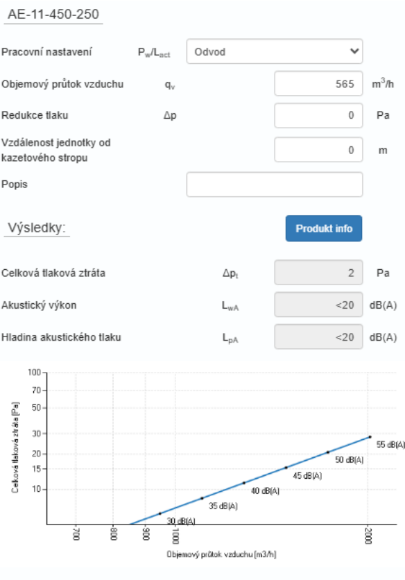
Obrázok č. 7: Parametre výustky AE
